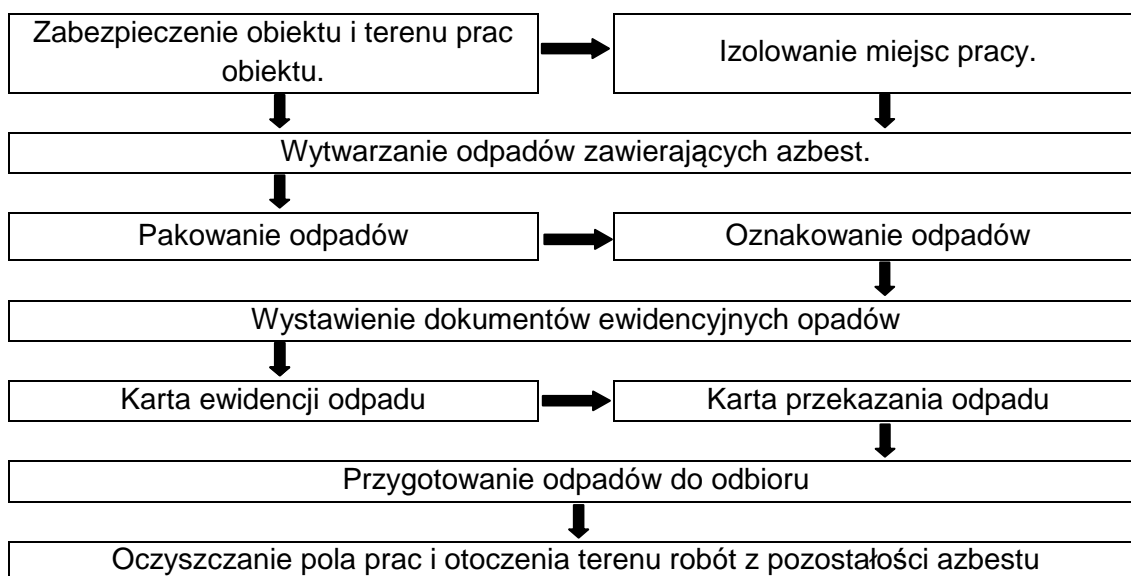
Rysunek 5. Schemat procedury dotyczącej prac polegających na usuwaniu wyrobów zawierających azbest, wytwarzania odpadów niebezpiecznych wraz z oczyszczaniem obiektu/terenu/instalacji.
