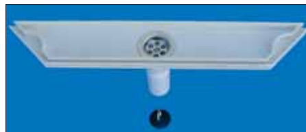
Końcówka odwadniająca do wodoodpornych naświetli z wlotem sitkowym odpływowym, zatyczką i końcówką do połączenia o średnicy 50 mm
